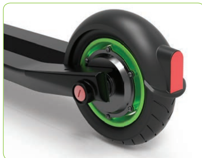
BEZKARTÁČOVÝ MOTOR V NÁBOJI ZADNÍHO KOLA
